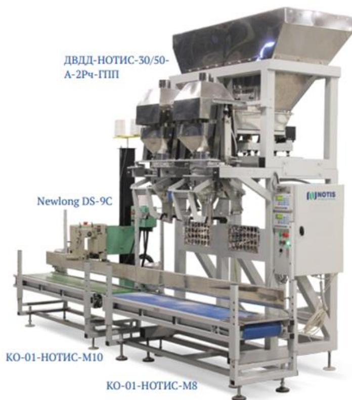
Линия предназначена для фасовки сыпучих продуктов в готовые мешки открытого типа, с последующей зашивкой.
