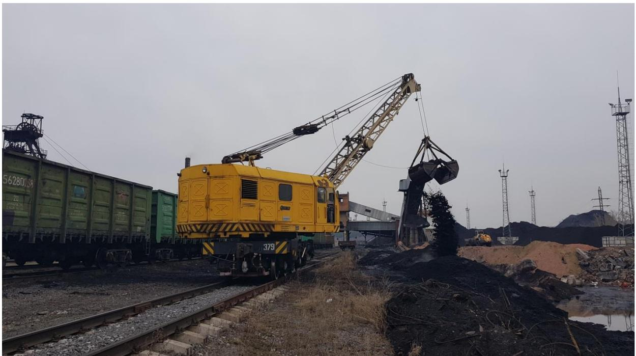
Рисунок 2.4.3 – Общий вид разгрузки полувагонов грейфером
